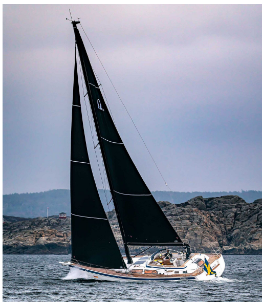
Рис. 1 (б). Існуючий проект компанії Hallberg-Rassy [2] (б) з фотоелементами, вбудованими у вітрила
