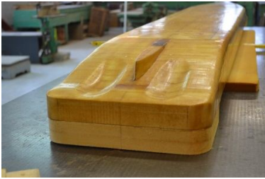
Рис. 3. Кормовий край і днище моделі пасажирського судна
