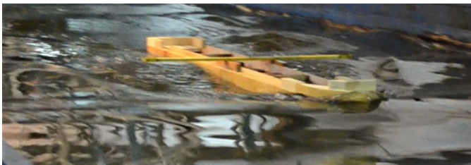
Рис. 14. Буксирування моделі на глибокій воді на регулярному хвилюванні, \lambda/L = 0,625 :
