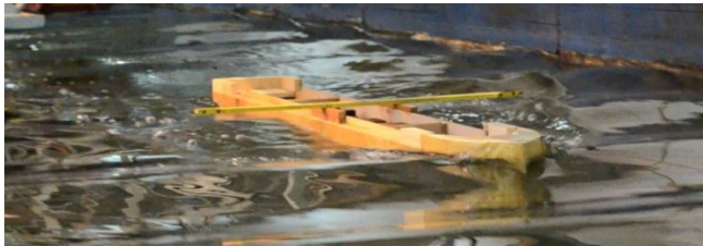
Рис. 13. Буксирування моделі на глибокій воді на регулярному хвилюванні \lambda/L = 0,5 :
