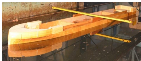
Рис. 6. Модель перед запряжкою в буксирувальну систему
