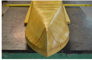
Рис. 4. Встановлення турбулізаторів, вид на носовий край
