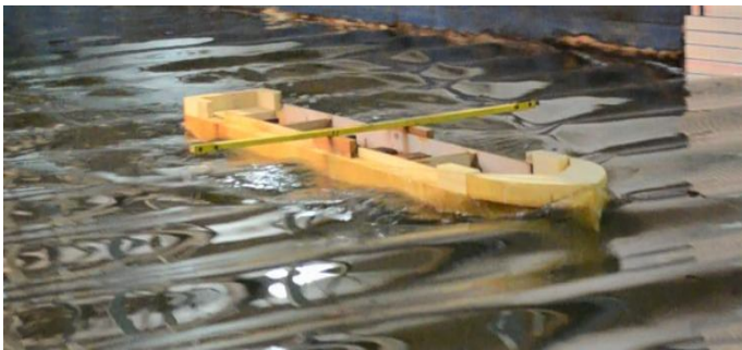
Рис. 12. Буксування моделі на глибокій воді на регулярному хвилюванні \lambda/L = 0,25 :
