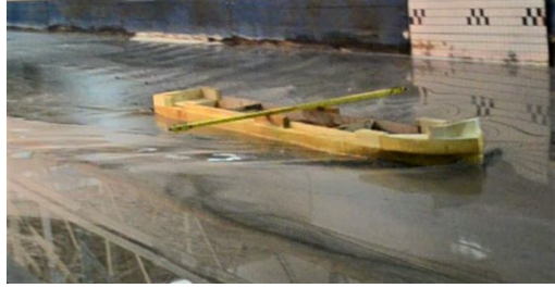
Рис. 8. Буксування моделі на глибокій воді зі швидкістю, близькою до розрахункової Fr = 0,183
