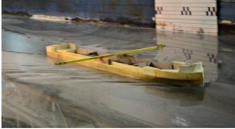
Рис. 7. Буксування моделі на глибокій воді із середніми швидкостями, Fr = 0,145
