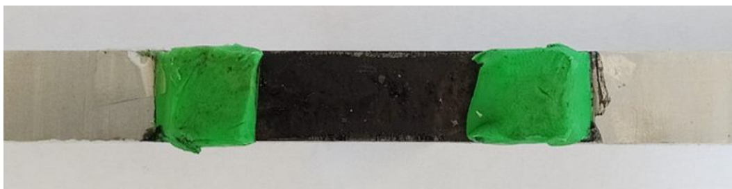
Рис. 2. Геометрія балкового зразка для визначення втомної витривалості сталей (а), його адаптація для використання СТС (б) та поверхня після витримуванні в СТС (в)
