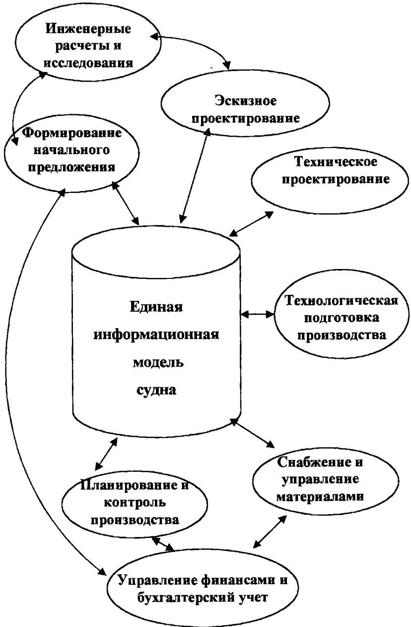
Рис. 3. Обобщенная схема ИУС судостроительного предприятия
