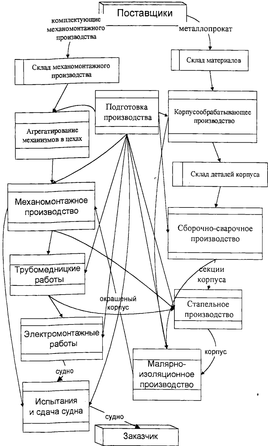
Рис. 1. DFD-модель судостроительного производства
