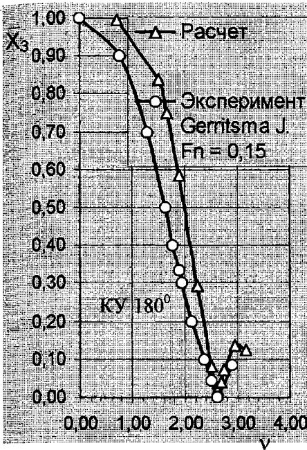
Рис 3. Возмущающие силы при продольной качке, модель №8, C_b = 0,8
