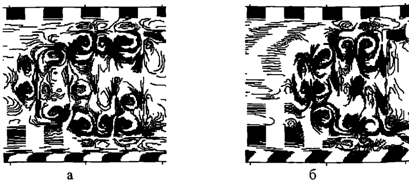
Рис. 2. Изолинии поля завихренности перед диском: а – t = 378,7 сек.; Re = 500 ; б – t = 17 сек.; Re = 10^4 Поток движется слева направо
