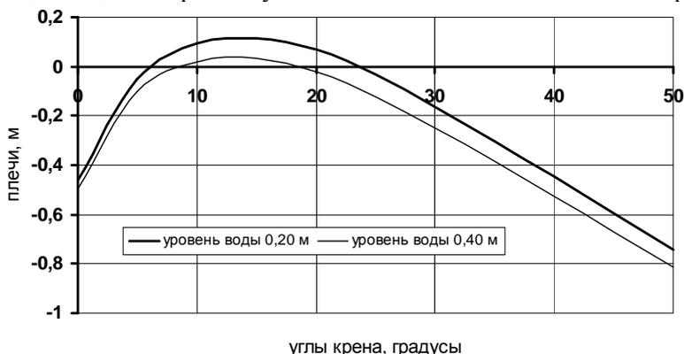
Рис. 6. Диаграммы статической остойчивости после смещения груза и затопления сухих отсеков № 4 и 5 на 0,20 и 0,40 м
