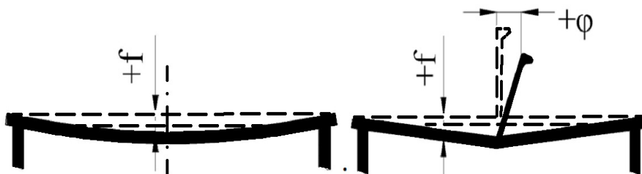
Рис. 3. Тип начальных деформаций пластин и ребер
