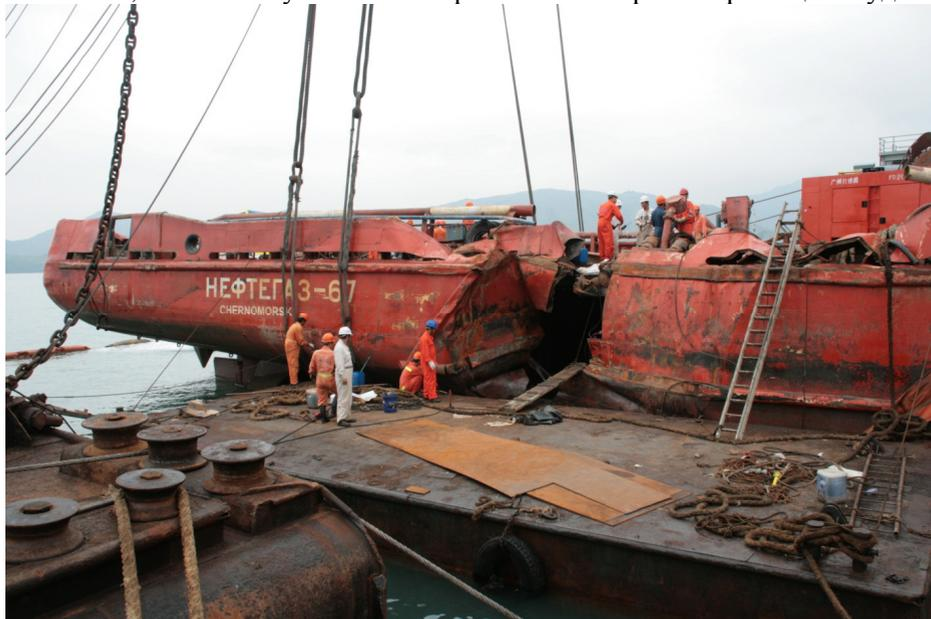
*Рис. 2. Повреждения тбс «Нефтегаз-67» в районе ширстрека*
