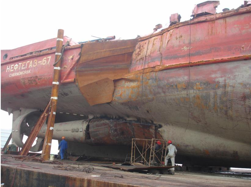
*Рис. 3. Повреждения тбс «Нефтегаз-67»
