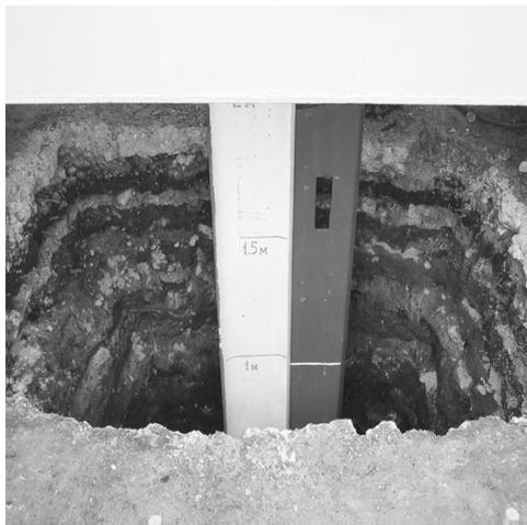
*Рис. 3. Подвижный свайный элемент (справа), вдавливаемый и извлекаемый через замковое соединение фиксированного элемента*
