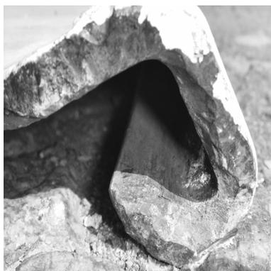
*Рис. 2. Замок шпунтовой сваи после ее извлечения*
