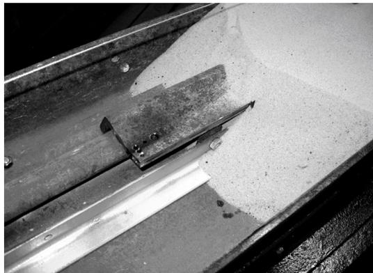
*Рис. 7. Лабораторное моделирование взаимодействия песчаного грунта с замковыми соединениями шпунтовых свай*
