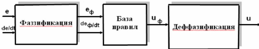
*Рис.2. Структурная схема фаззи-регулятора*
