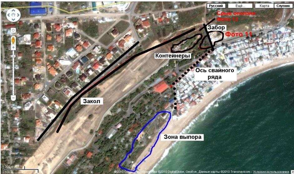
Рис. 2. Результаты визуального обследования оползневого массива
