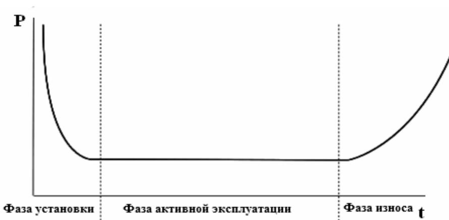
Рис.1. Модель кривой отказов технического узла
