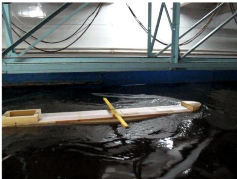
Рис.2. Движение модели в условиях регулярного волнения
