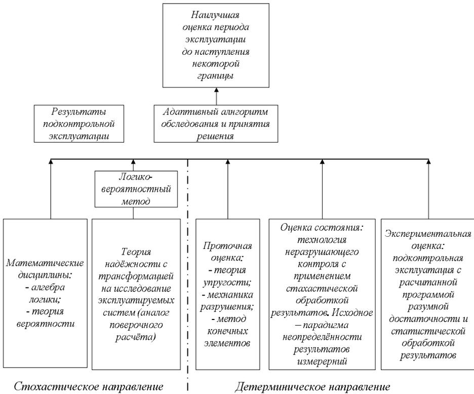
Рис. 3. Схема алгоритма прогнозирования состояния ТС
