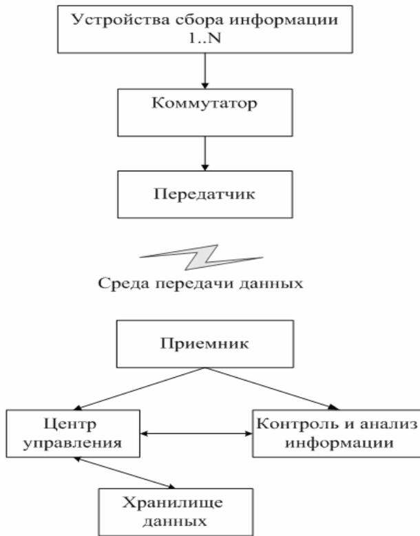
Рис. 1. Типовая структура СМДП
