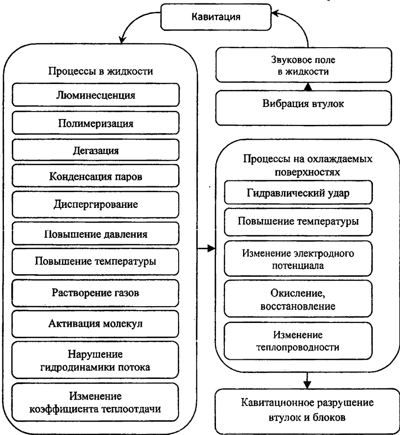
Рис. 1. Схема процесса кавитационного разрушения охлаждаемых полостей СДВС
