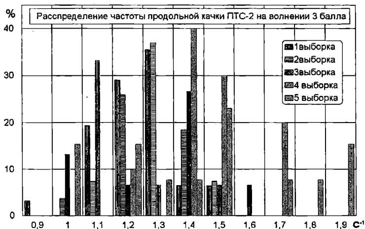
Рис.5. Спектр частот продольной качки плавающей машины в зависимости от ее скорости движения в разрез волне: 1- при v = 0 м/с; 2- при v = 1,39 м/с; 3 - при v = 1,944 м/с; 4 - при v = 2,22 м/с; 5 - при v = 2,5 м/с; 6 -при v = 2,78 м/с; 7- при v = 3,06 м/с
