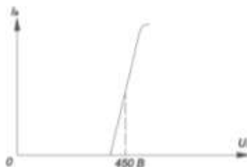
Рис. 4.23 – Зовнішня характеристика AVR
