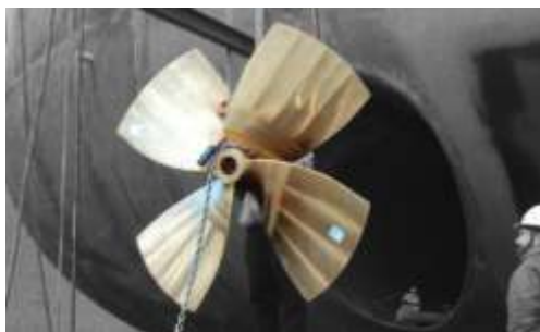
Рис. 5.5. Монтаж ТПУ на споруджуваному судні.
