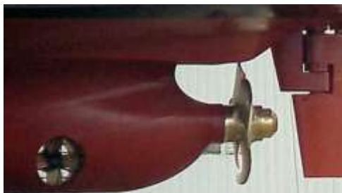
Рис. 5.3. Зовнішній вигляд кормових ТПУ, вмонтованих перед гребним гвинтом.
