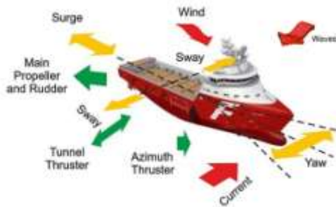
Рис. 5.10 Зовнішні сили, які впливають на судно, реакція судна на ці впливи і суднові пристрої для утримання позиції.
