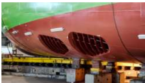
Рис. 5.9. ТПУ інноваційної конструкції в корпусі судна
