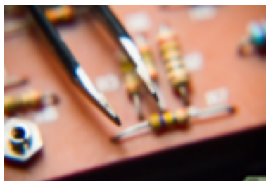
Рисунок 2.17 - Від'єднання одного контакту резистора від кола
