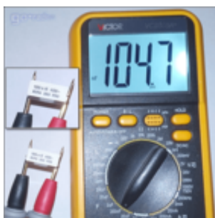
Рисунок 3.56 - Вимірювання ємності справного конденсатора
