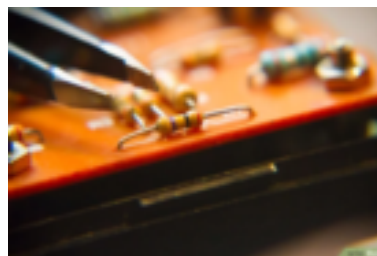
Рисунок 2.21 - Запаювання справного резистора
