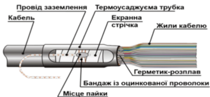
Рисунок 8.24 – Кінцева муфта з термоусадкою
