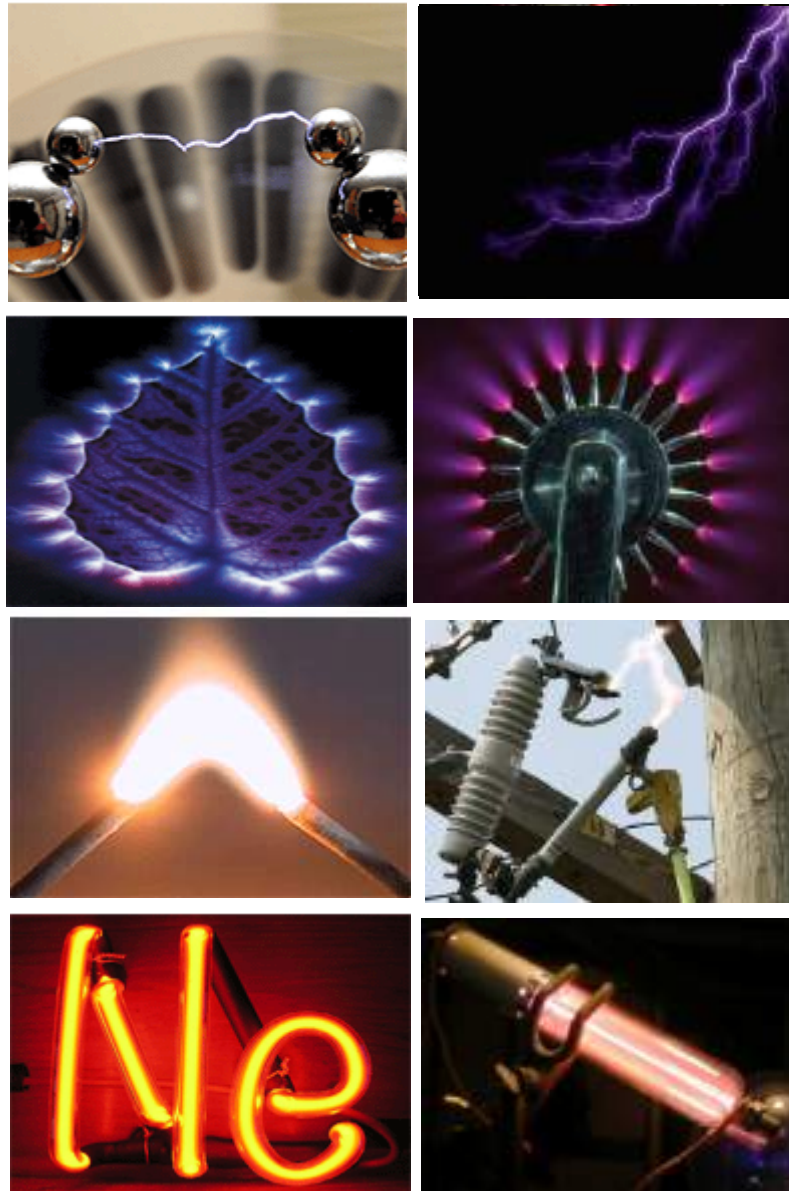
Рис.2.10 Основні види розряду в газах а – іскровий; б – коронний; в – дуговий; г – тліючий
