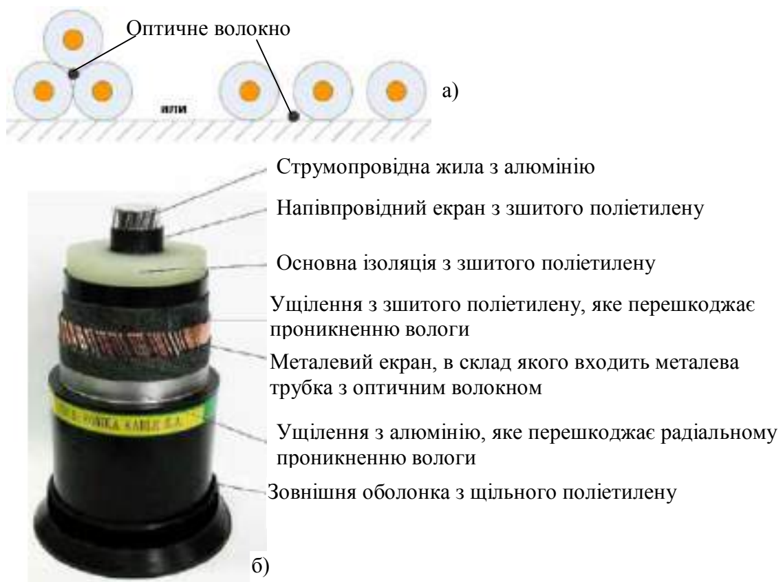
Рис.3.39 Розташування окремого оптичного волокна в кабельних трасах (а) та конструкція спеціального силового високовольтного кабелю з оптичним волокном (б)
