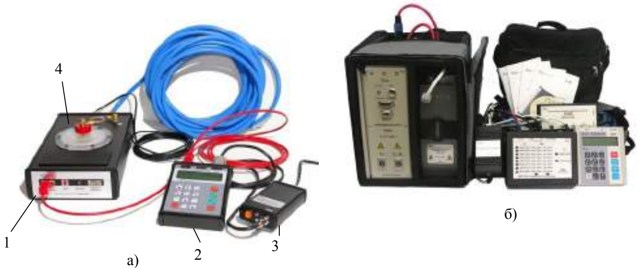
Рис.3.31 Прибори для вимірювання ємності та \operatorname{tg} \delta на основі високовольтного моста змінного струму Шерінга
