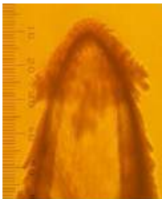
Рис.3.10 Вигляд водних трингів у XLPE ізоляції
