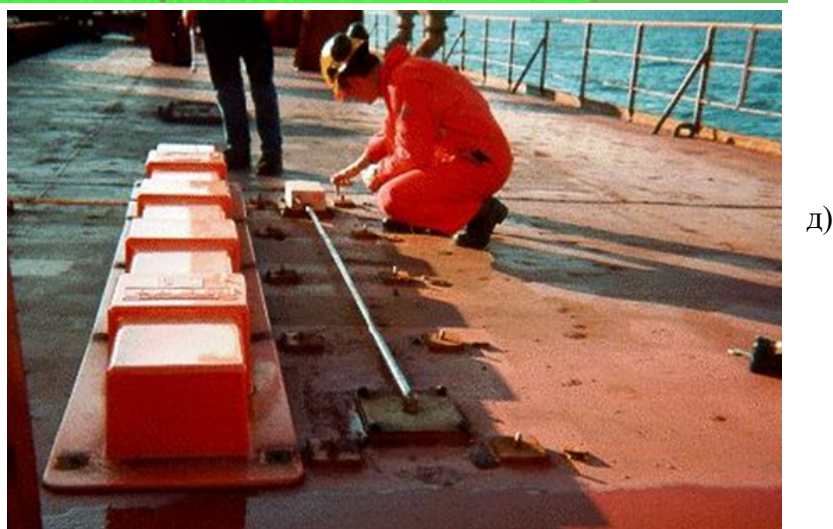
Рисунок 1.20 – Дротові тензорезистора для вимірювання напружень в корпусі судна:
