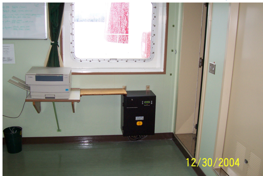
Рис.1.34 Зовнішній вигляд DCU реєстраторів даних рейсу різних виробників (а) та приклад розташування блоку DCU на мостіку (б)
