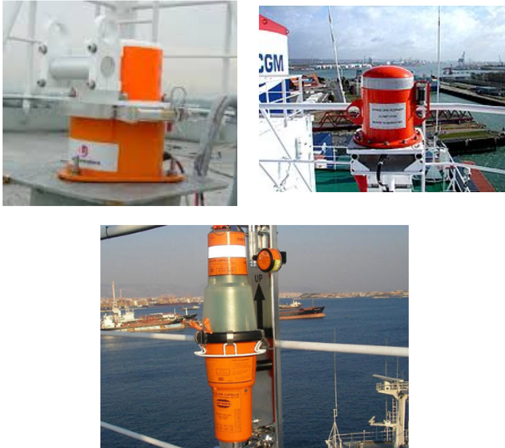
Рис. 1.38 Встановлення захисної капсули стаціонарного типу на судні
