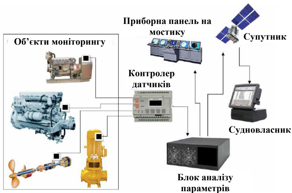
Рис.1.9 Структурна схема моніторингу судових систем
