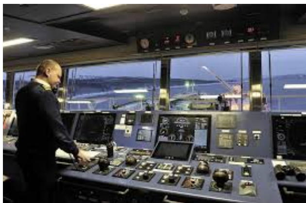
Рис.1.6 Приклади зовнішнього дизайну інтегрованої системи ходового мостика
