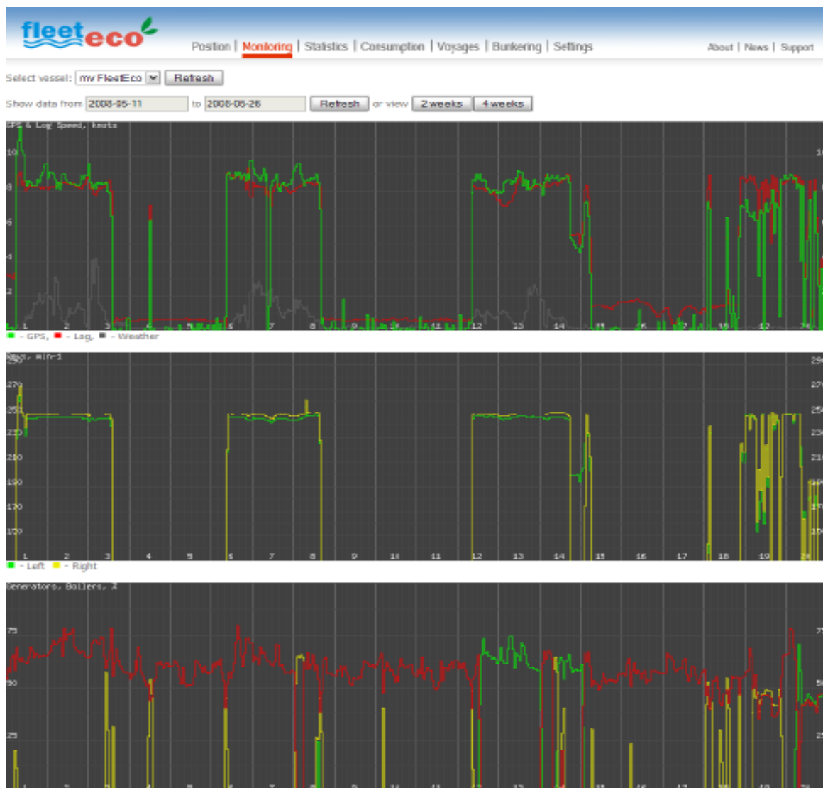
Рис.1.23 Розділ « Monitoring » - графіки моніторингу руху судна та параметрів головних двигунів:
