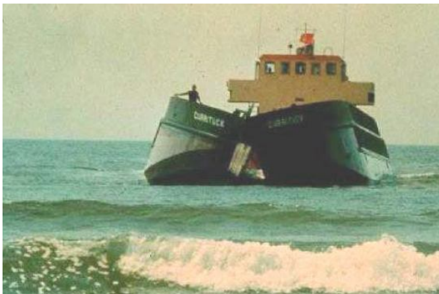
Рис. 5. Самохідний роздільнокорпусний бункерний земснаряд з саморозвантажувальним механізмом відсіпки каменю
