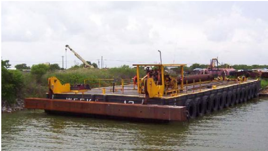
Рис. 9. Вирівнювач дна, підвішений до робочої баржі (фото надано WeeksMarine, Inc., Кренфорд, Нью-Джерсі) [5]
