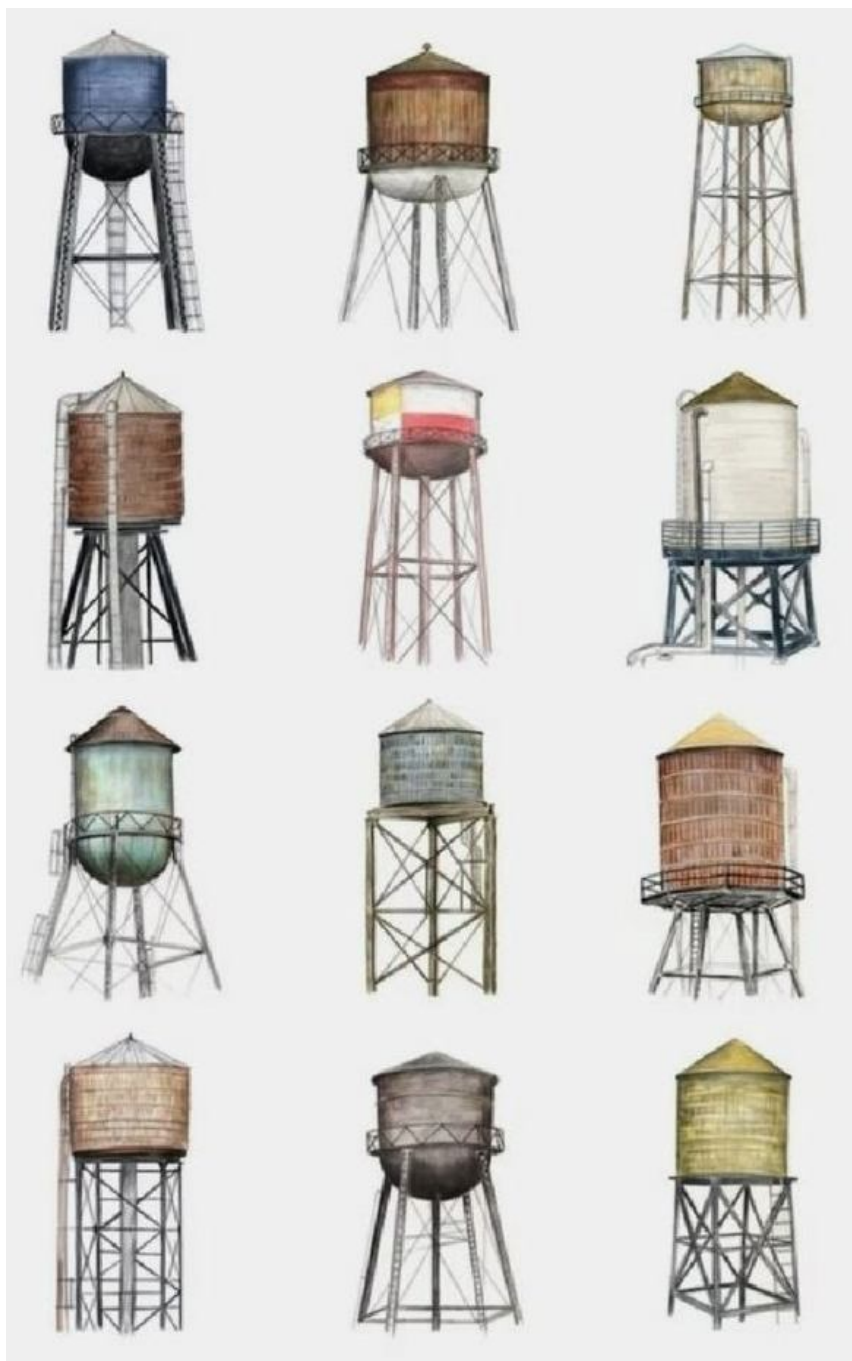
Рис. 2. Різновиди каркасних веж
