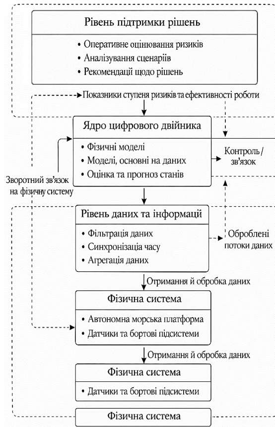
Рис. 2. Архітектура цифрового двійника автономної морської платформи
