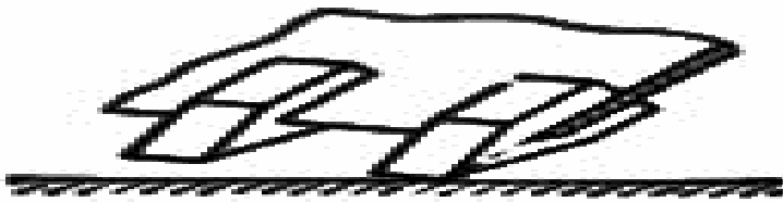
Рис. 1. Ніж розпушувача земснаряду
