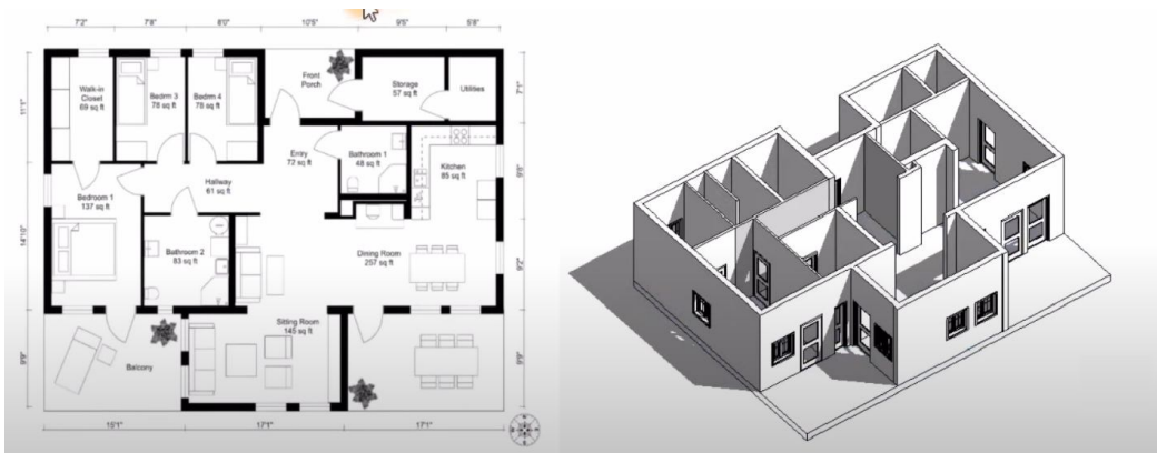
Рис. 14. Вихідний план будівлі та модель, що генерована у Revit за допомогою WiseBIM AI
